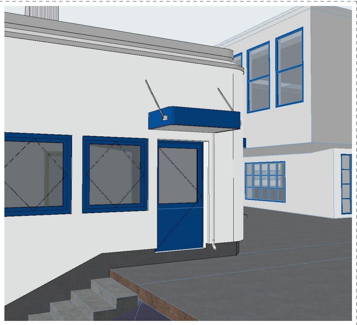
Illustrasjon Tak over rømningsdør øst
